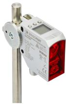
Halterung (Zinkdruckguss) für Schwalbenschwanz F 55-Metallgehäuse an Stangen ø 12 mm und Vierkantprofilen 10x10 mm
