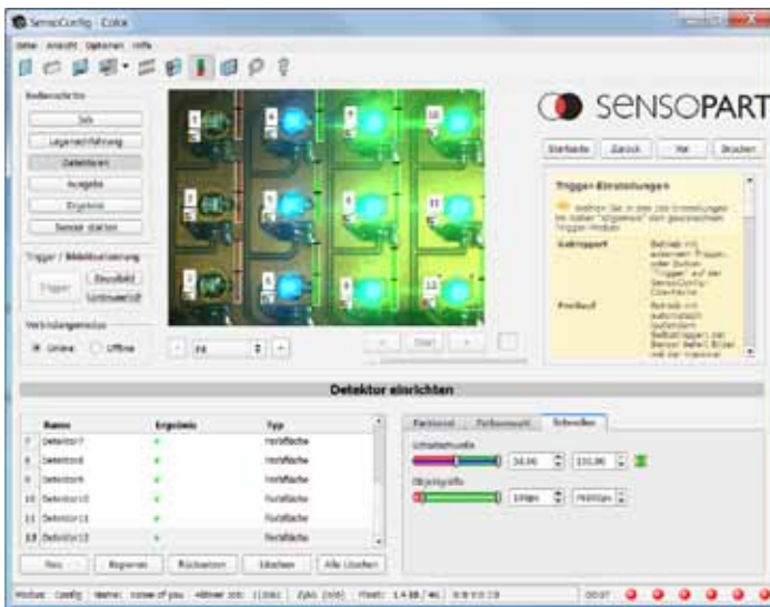
Abb. 1: Mit einem Vision-Farbsensor wie dem Visor Color von SensoPart lassen sich auch aktive (selbstleuchtende) Farben erkennen. In dem im Bild gezeigten Beispiel werden die Elemente eines Automobil-Farbdisplays auf Funktionsfähigkeit und korrekte Bestückung geprüft. In der Konfigurationssoftware werden die Farben und ihre Toleranzbereiche sowie die jeweiligen Positionen vorgegeben.
