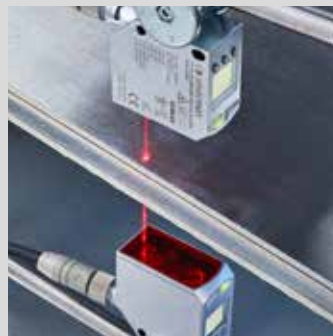
Fonctionnement en Maître-Esclave pour la mesure d'épaisseur d'un matériau ou d'une double couche
