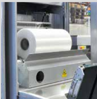
Contrôle continu du diamètre d'une bobine sur des machines d'emballage par exemple
