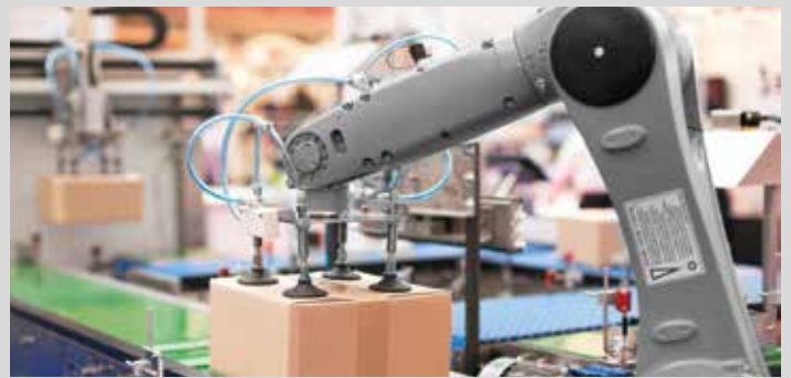
Mesure de la hauteur d'un carton, pour que celui-ci puisse être saisi par un robot
