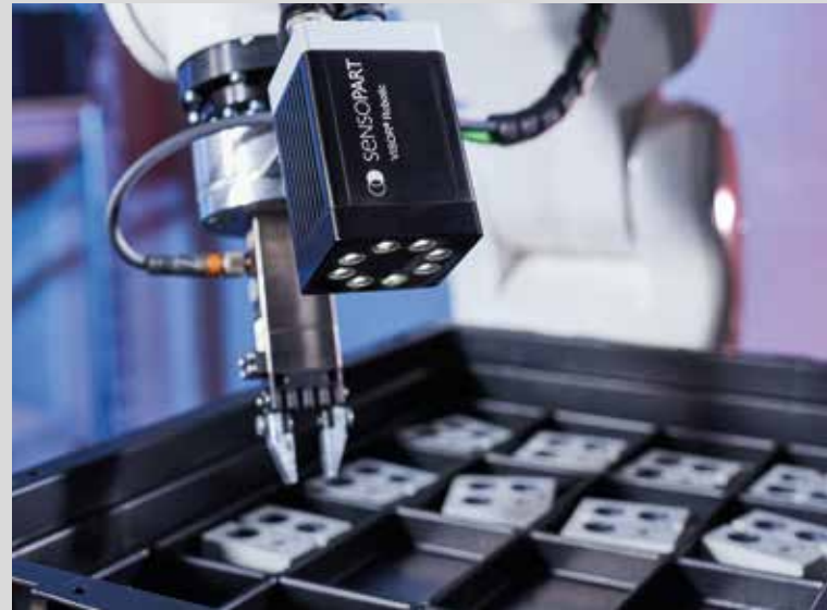
Le VISOR® Robotic détecte la position du composant sur un convoyeur. La prise peut ainsi être faite avec précision. Afin de coller au mieux avec votre production, le capteur est capable de contenir 255 programmes pour des pièces différentes.
