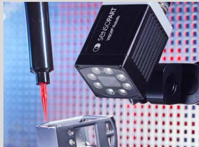
Le VISOR® Robotic localise précisément la position du boîtier du capteur. Les données de positions sont ici utilisées pour corriger la trajectoire du robot.
