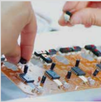
Überprüfung der Montagegenauigkeit bzw. der Anwesenheit von Bauelementen
