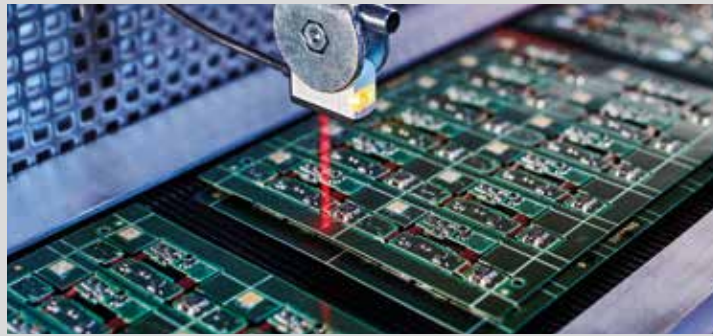
Erkennung von Doppellagen von Leiterplatten, bzw. Höhen- und Anwesenheitskontrolle von Bauteilen
